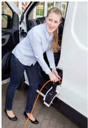
Einspeisung für 230 V Standkühlung
